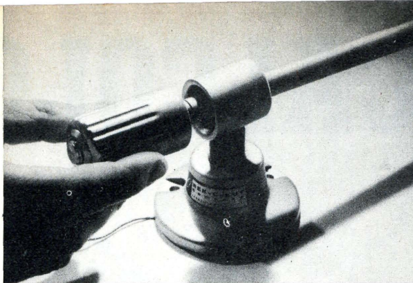
Il contrappeso è tenuto in posizione nel braccio Rek-o-Kut da una vite interna caricata da una molla. Un solo giro del contrappeso fa variare esattamente di mezzo grammo la pressione della puntina sul disco.
