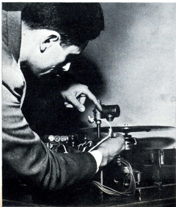
Una lampada posta sopra al disco in corrispondenza della pellicola, irradia un raggio di luce sulla pellicola stessa, iniziando il principio tecnico della invenzione.
